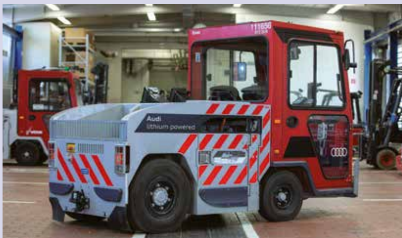
▲ Tovarniški traktor za vlečenje na pogon, ki se napaja iz rabljenih litij-ionskih baterij v obratu podjetja Audi v Ingolstadtu
