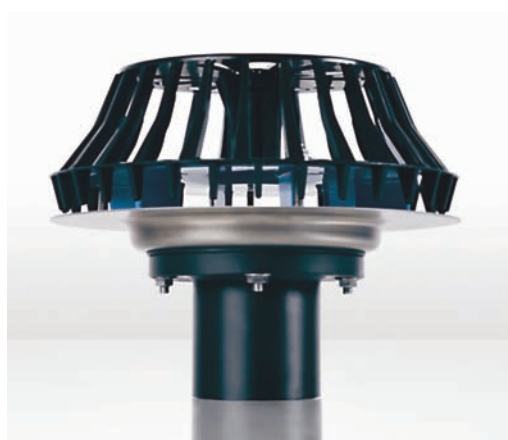
Slika 7 Celoten vtočnik Rainplus 56 je prekrit z zaščitno košaro premera 180 mm, ki preprečuje vstop nečistoč v odvodni sistem. Osnovni krožnik in umirjevalni pokrov sta kovinska, košara in odtočna cev pa sta iz umetne mase. Kapaciteta vtočnika je do 14 l/s in je primeren za žlote širine vsaj 20 cm ali manjše strehe
