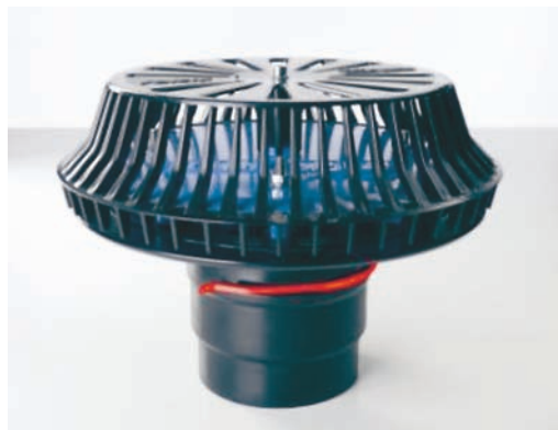
Slika 6 Celoten vtočnik Rainplus 40-110 je prekrit z zaščitno košaro premera 286 mm, ki preprečuje vstop nečistoč v odvodni sistem. Osnovni krožnik, prirobnica in umirjevalni pokrov so kovinski, košara in odtočna cev pa sta iz umetne mase. Velika kapaciteta ga uvršča med najbolj zmogljive vtočnike na svetu
